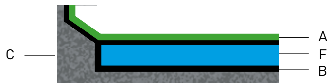
KUVIO 6: REUNARAKENNE SEINÄN PUOLELLA
