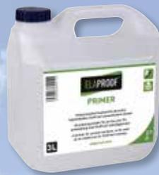
El PRIMER ElaProof es una imprimación de base acuosa, respetuosa con el medio ambiente, que mejora la adherencia del revestimiento a los materiales porosos antes del revestimiento ElaProof. El tratamiento mejora la adhesión de ElaProof al sustrato y tapa los poros del sustrato. Las burbujas de aire que suben a la superficie suelen ser señal de una imprimación insuficiente. Adecuado para su uso en interiores y exteriores.
